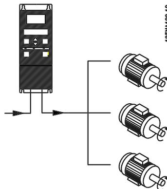
El convertidor de potencia puede controlar varios motores conectados en paralelo. Si hace falta que los motores tengan diferentes valores de rpm, utilice motores con diferentes valores nominales de rpm. El valor de rpm del motor cambia simultáneamente, lo que significa que la relación entre los valores nominales de rpm se mantiene en todo el rango. El consumo total de intensidad de los motores no debe sobrepasar la intensidad de salida nominal  $I_{NIV}$  para el convertidor de frecuencia.
