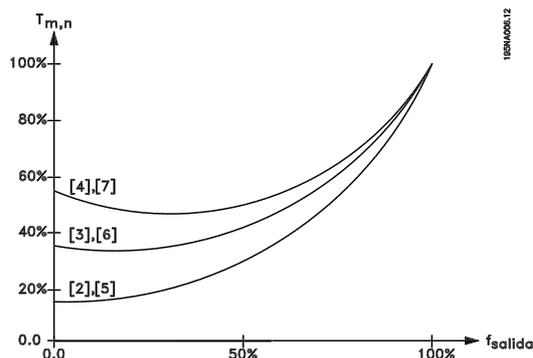
Seleccione *Modo de motor especial* [8], si se necesita un ajuste de U/f especial para adaptar el motor. Los puntos de interrupción se ajustan en los parámetros 423-428 *Tensión/frecuencia*.
