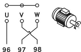
Según el ajuste de fábrica, el motor gira en el sentido de las agujas del reloj con la salida del transformador del convertidor de frecuencia conectada del modo siguiente:
