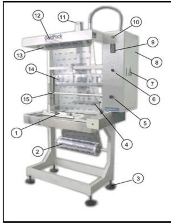
Figura # 2, Envolvedora Manual Neumática SRMN.
