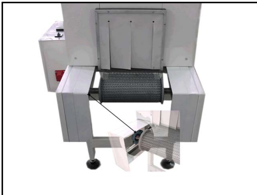
Figura #10, Detalle Chumaceras corredizas(a ambos lados de la banda transportadora).
