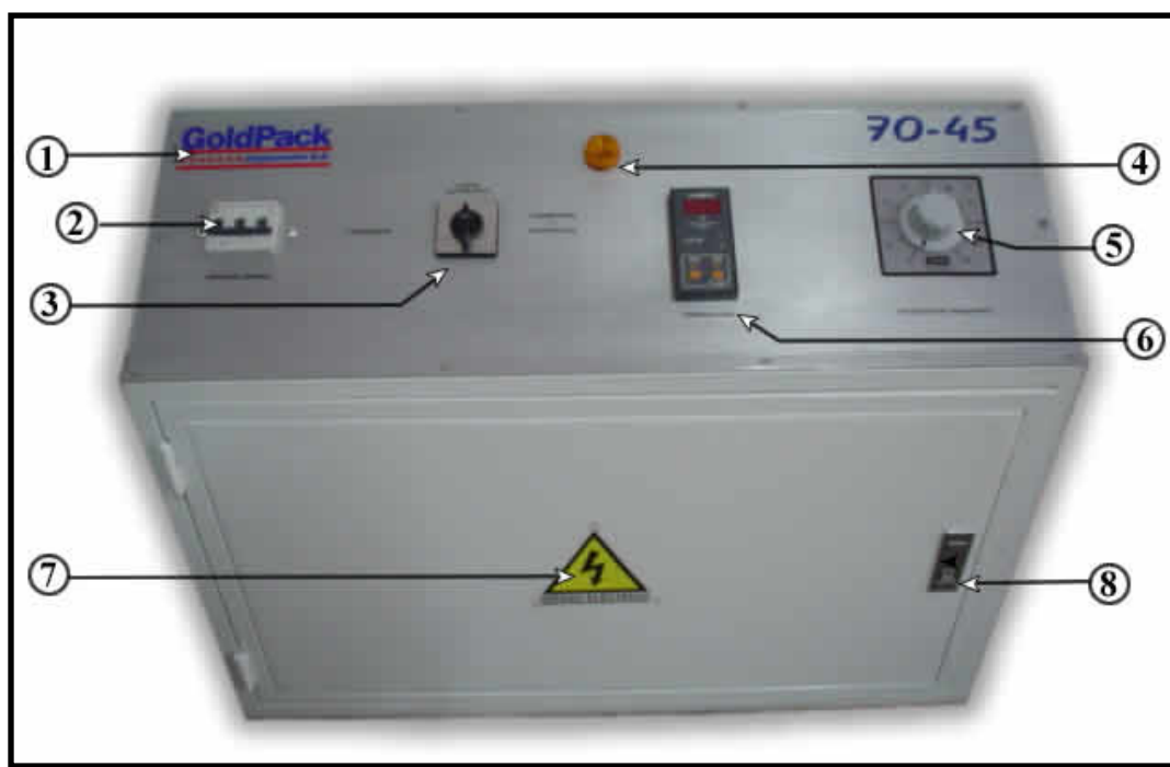
Figura #3 , Tablero de control Túnel de termocontracción 70 – 45.
