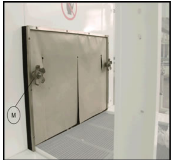
Figura # 6, Manillas para graduar los alerones
