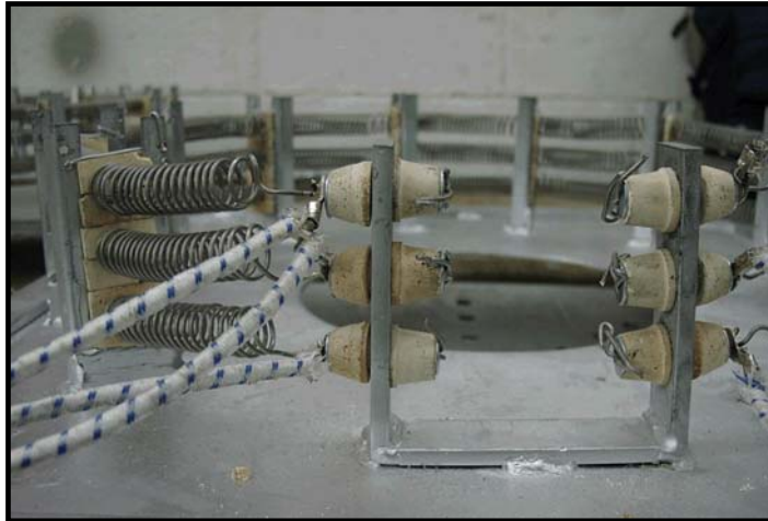
Figura # 9, Detalle de las resistencias.
