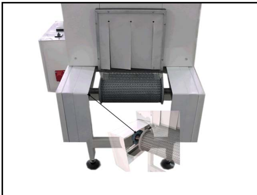
Figura # 9, Detalle Chumaceras tensoras (a ambos lados de la banda transportadora).
